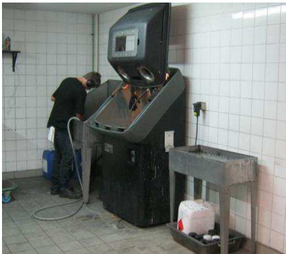
Autres bacs / fontaine de lavage à l'eau
